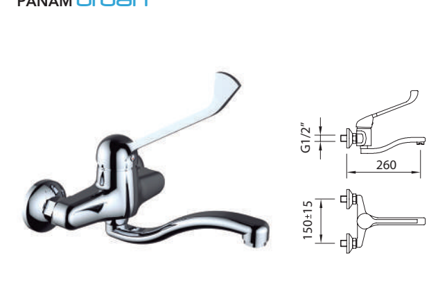
FREGADERO MURAL CON MANETA GERONTOLÓGICA / Wall mounted sink mixer with medical lever / Mitigeur évier mural, avec manette médicale
