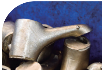
4 Extracción noyo arena Sand core pullers extraction Extraction des noyaux de sable
