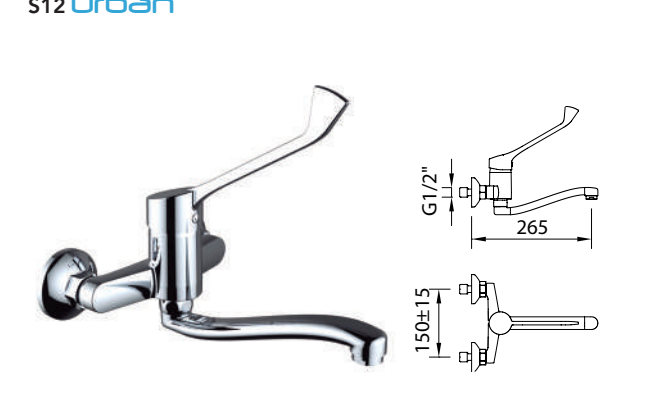
FREGADERO MURAL CON MANETA GERONTOLÓGICA / Wall mounted sink mixer with medical lever / Mitigeur évier mural, avec manette médicale
