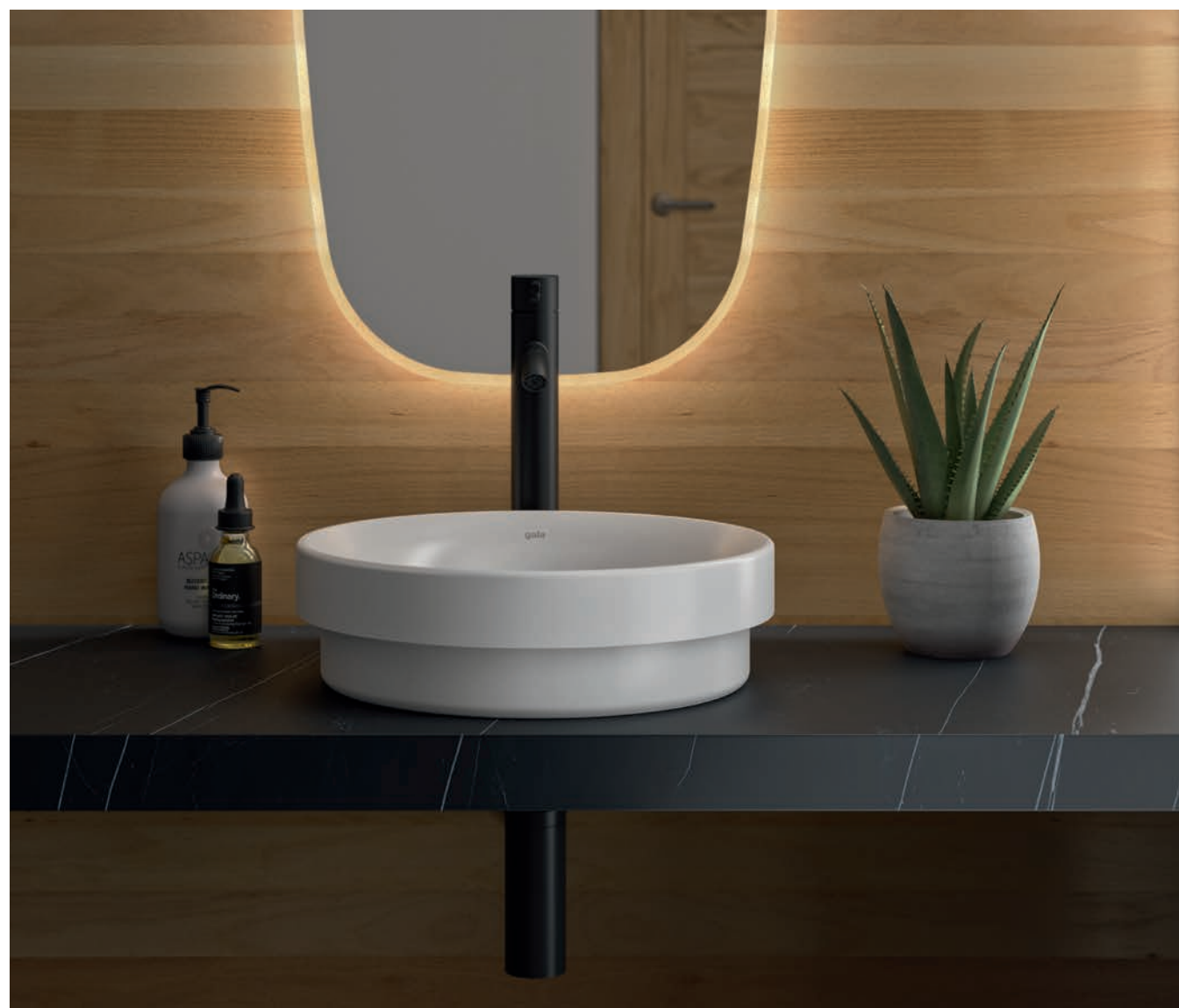
04330 CIRCLE Ø 39,5 cm Sin rebosadero. Sin orificio de grifería. Posibilidad de instalación sobre-encimera, encimera o semiempotrar. Plantilla de corte de Ø 31,2 cm para instalación sobre-encimera.
