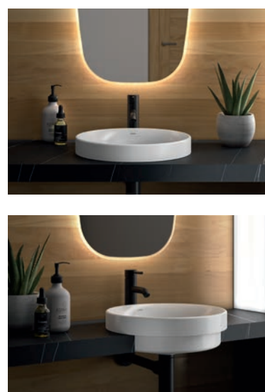
04330 CIRCLE Ø 39,5 cm Sin rebosadero. Sin orificio de grifería. Posibilidad de instalación sobre-encimera, encimera o semiempotrar. Plantilla de corte de Ø 31,2 cm para instalación sobre-encimera.
