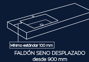
Mínimo estándar 100 mm MUEBLE SENO DESPLAZADO desde 900 mm (enviar cotas del mueble)
