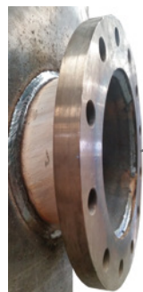
Boca de Registro DN 400
