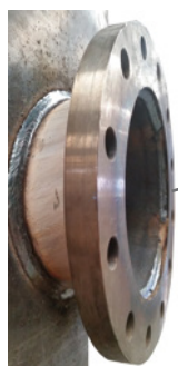
Boca de Registro DN 400
