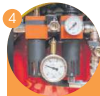
4 Tratamiento de aire/ Treatment of air
