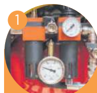
Tratamiento de aire/ Treatment of air
