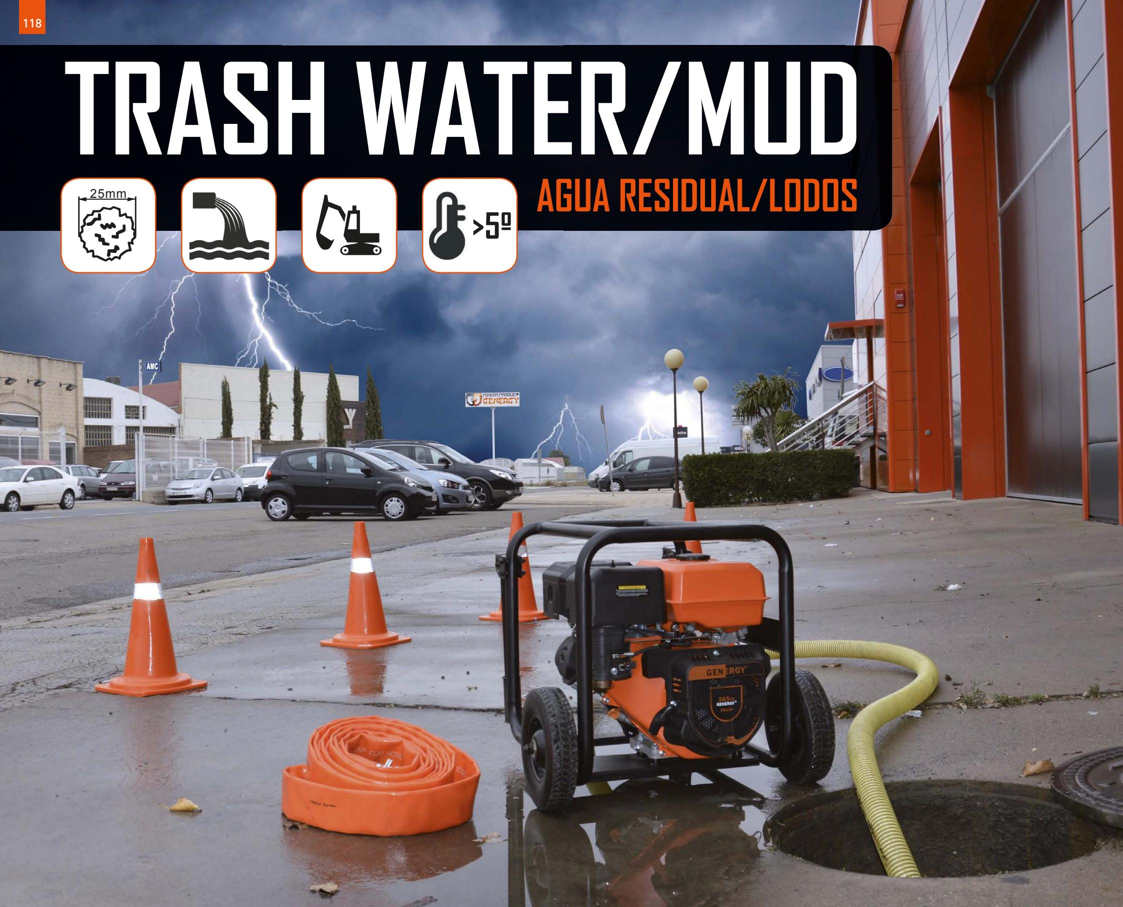
La holgura de paso entre la turbina y la voluta o caracol ha sido sobredimensionada para permitir el paso de sólidos de hasta 25mm de diámetro. En caso de atascos en la bomba, estos pueden ser fácilmente solventados gracias al sistema de rápida y completa apertura de la bomba y sin necesidad de herramientas. Ideal para achique de agua residual en inundaciones, trasvases o riegos.
