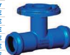
GGG-50 Recubrimiento EPOXI Junta EPDM PN - 10/16/25
